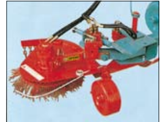
Coltello rasatore per togliere l'erba senza smuovere il terreno Blade to remove the grass without disturbing the soil Messer zum Grasmähen ohne Bodenbewegen. Couteau faucheur pour enlever l'herbe sans remuer la terre. Cuchilla alisadora para quitar la hierba sin remover el terreno.
