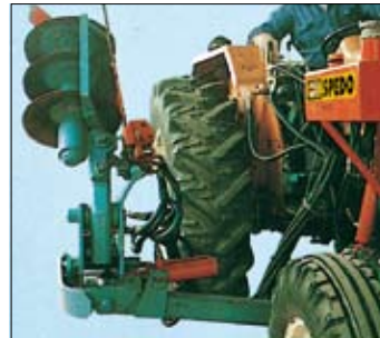
Testata idraulica movimento verticale Vertically driven hydraulic head Hydraulischer Kopf für die senkrechte Bewegung Tête hydraulique mouvement vertical Cabeza hidráulica movimiento vertical
