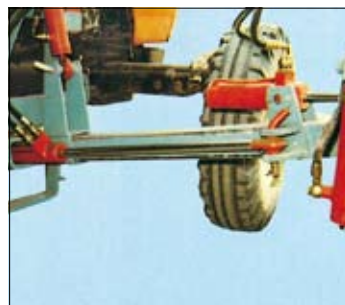
Sfilo idraulico laterale Hydraulic side extension Hydraulischer Seitenauszug Bras télescopique hydraulique latéral Dispositivo hidráulico lateral
