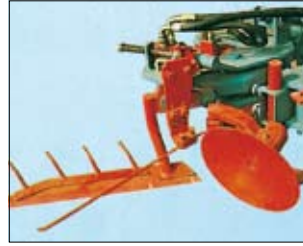
Coltello rasatore per togliere l'erba senza smuovere il terreno Blade to remove the grass without disturbing the soil Messer zum Grasmähen ohne Bodenbewegen. Couteau faucheur pour enlever l'herbe sans remuer la terre. Cuchilla alisadora para quitar la hierba sin remover el terreno.
